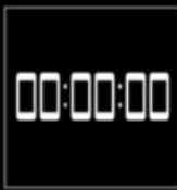
Нажмите на экран таймера (удерживайте примерно 1 секунду). Настройка таймера осуществляется с помощью прокрутки. Подтвердите изменения нажатием (удерживайте примерно 1 секунду). Без подтверждения экран настройки исчезнет (примерно через 8 секунд).
